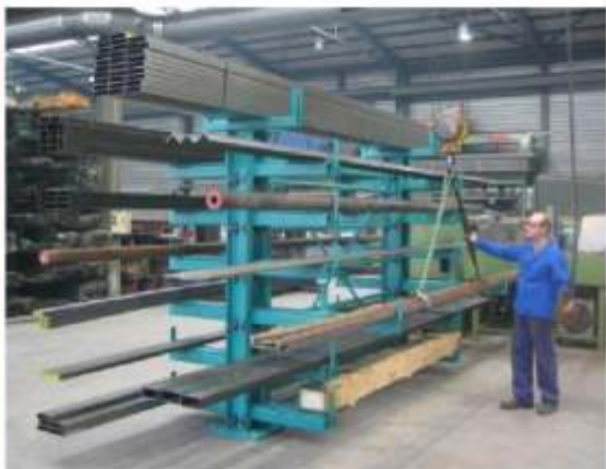
Jeder Arm mit Kran bedienbar Each arm can be operated by crane
